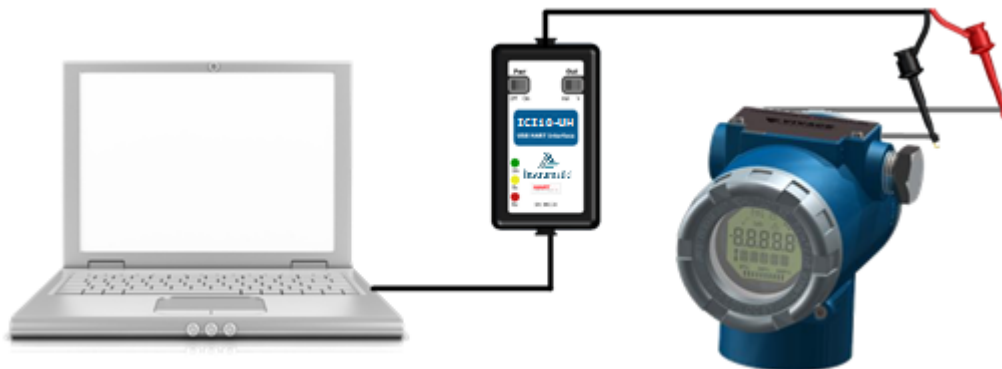
Figura 2.2 - Configuração da interface com alimentação do equipamento via interface.
