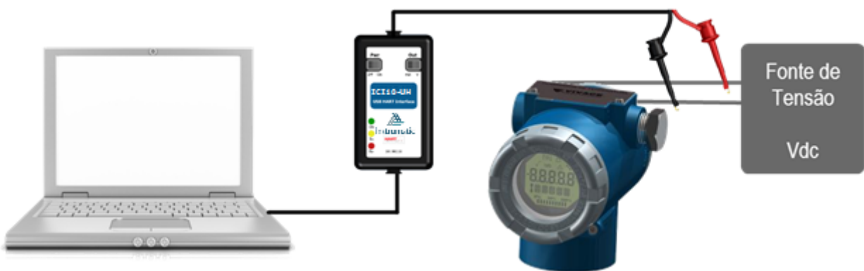
Figura 2.1 - Configuração da interface com alimentação externa do equipamento.
