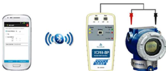
Quando este modo de operação é selecionado, a ICI10-BP pode alimentar diretamente o instrumento a ser configurado ou parametrizado, e ainda, trabalhar em paralelo com equipamentos já energizados por um acoplador PROFIBUS DP/PA.
