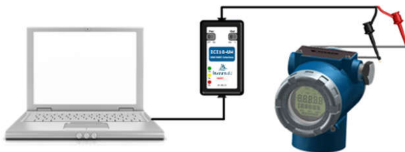
Equipamento alimentado pela VCI10-UH
